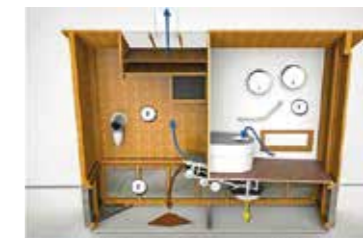
Fonctionnement des toilettes à lombricompostage
